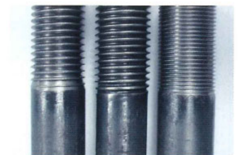
アンカーボルトのねじ形状 (左より 切削並目ねじ、転造並目ねじ、切削細目ねじ)
