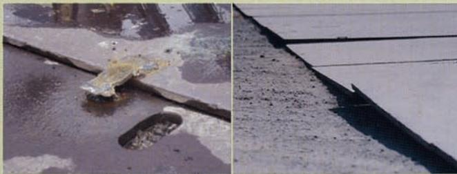
切り板鋼板溶接部の破断状況 / 端部の反り / 鉄板のパタツキ
