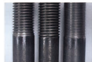
アンカーボルトのねじ形状 (左より 切削並目ねじ、転造並目ねじ、切削細目ねじ)
